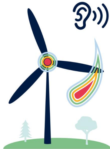
Figur 30 Illustration av var ljud uppstår vid ett vindkraftverk i drift.
